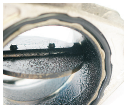
Regelklappe im verölten Zustand
